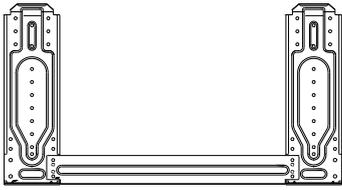
Antes de instalar la unidad asegúrese que la pared sea suficientemente fuerte y segura. Fije la placa soporte con 4 tornillos. Asegúrese de mantener el correcto nivel. De otra manera podrán producirse pérdidas de agua durante el funcionamiento.
